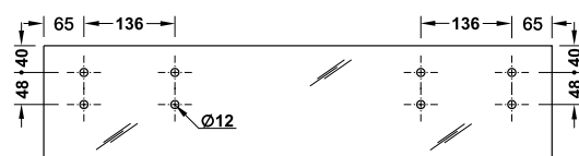
Panel preparation detail Chi tiết khoan cắt cửa
