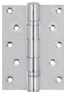
Butt hinge 2BB 102 x 76 x 2.5mm Bản lề lá hai vòng bi cho cửa 70kg
